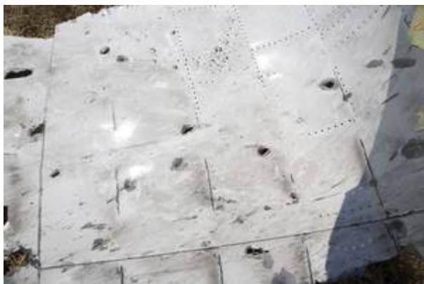
Einschusslöcher an der Außenhaut
