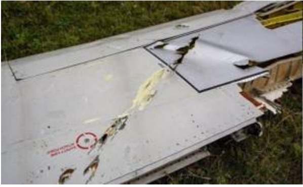
Streifschuss an der Tragfläche
