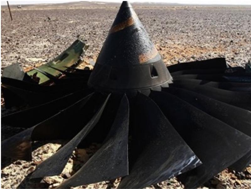
Lo mismo sucede con la hipótesis de la explosión de uno de los tanques de carburante ya que estos están situados en las alas del avión y la explosión de uno de ellos habría desprendido del fuselaje el ala afectada. Las dos alas del avión cayeron a tierra enteras, a pocos metros de la parte delantera del fuselaje y se quemaron posteriormente, lo cual indica que no se desprendieron del fuselaje y que no hubo incendio en los tanques de carburante antes del contacto con el suelo.
